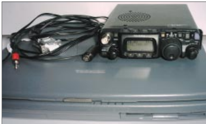
Bild 1: Das ist alles, was man für Packet-Radio braucht: einen PC, einen Transceiver und ein bißchen Kabel – den Rest managt die Software PCFlex32.
