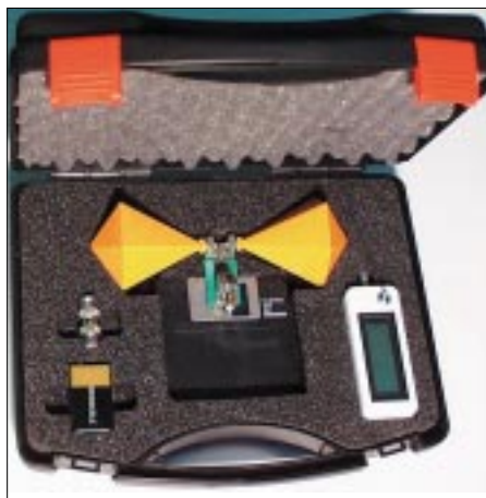
Der in [6] beschriebene Meßkoffer II von Sat-Service Schneider mit Breitbanddipol BMA1, Pegelmeßgerät PWRM2, BNC-BNC-Adapter, 9-V-Batterieblock und Diskette mit Daten Werkfoto
