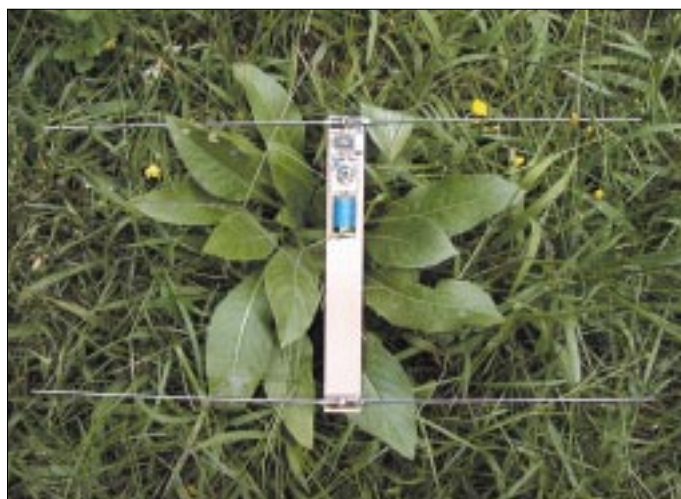
Bild 7: Gesamtansicht des Empfängers, hier als Laboraufbau, bei dem die Platine als Antennenträger dient Fotos: DL7UNO
